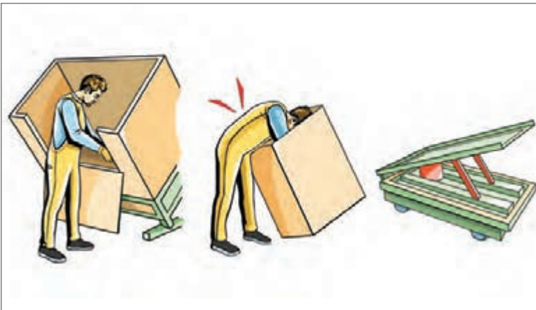
■ شکل ۳۴-۴- طراحی ارگونومیک پایه یک جعبه
